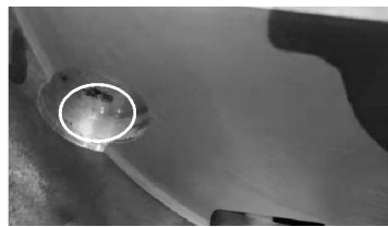
图 4 加工后的缩孔 Fig.4 Shrinkage hole after machining
